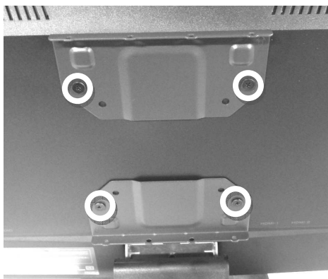
モニター取り付けネジ (M4 平頭×10mm)
